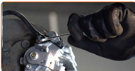
**25** Collega il tubo flessibile del kit di spurgo freno pneumatico alla valvola di spurgo del freno.
