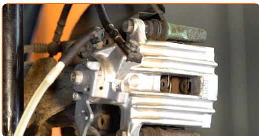
**26** Installa il cavo del freno di stazionamento nella staffa della pinza del freno. Usa le pinze per pompa ad acqua.
