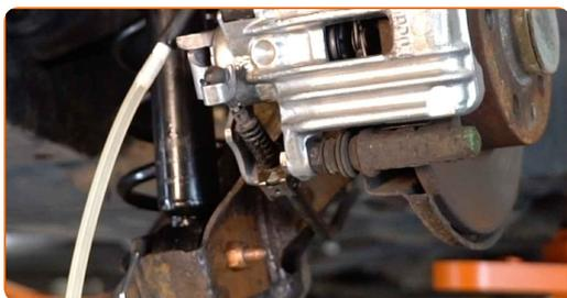
**27** Fissa il cavo del freno di stazionamento con il clip di fissaggio.
