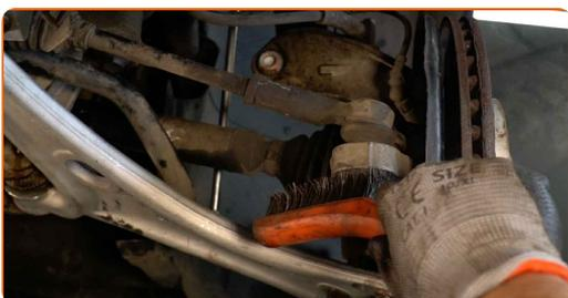
**7** Misura e memorizza la posizione precisa del giunto sferico sulla barra di accoppiamento, oppure conta il numero di giri completi al fine di evitare il disallineamento durante il montaggio successivo. Usa un calibro a corsoio.
