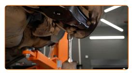
Serrare l'elemento che fissa il braccio alla trave. Utilizza una chiave combinata N°18. Utilizza una chiave a bussola N°18. Usa una chiave dinamometrica. Serralo fino allo coppia di torsione di 95 Nm.
