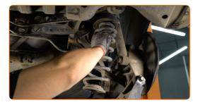
Svita gli elementi di fissaggio che collegano il braccio di sospensione allo snodo posteriore. Utilizza una chiave combinata N°18. Utilizza una chiave a bussola N°18. Usa una chiave a cricchetto.
