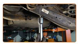
Allenta l'elemento di fissaggio che collega il braccio di controllo allo snodo posteriore. Utilizza una chiave combinata N°18. Utilizza una chiave a bussola N°18. Usa una chiave a cricchetto.
