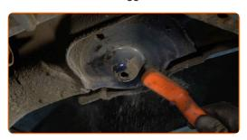
Installa la molla elicoidale insieme ai montanti di gomma nelle sedi di montaggio.
