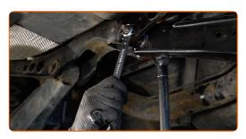
Sostituzione: braccio di controllo inferiore della sospensione posteriore - AUDI Q3 (F3B). Gli esperti di AUTODOC raccomandano:
