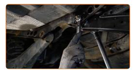
Serra gli elementi di fissaggio che collegano il braccio di sospensione allo snodo posteriore. Utilizza una chiave combinata N°18. Utilizza una chiave a bussola N°18. Usa una chiave dinamometrica. Serralo fino allo coppia di torsione di 90 Nm. +90°
