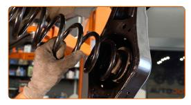
Puntellare il braccio. Usa un piede di porco. Usa un cric idraulico per trasmissione.
