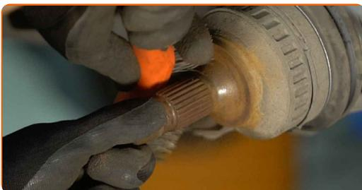
**32** Installare il fuso a snodo dello sterzo sull'assale CV.
