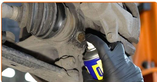
10 Svitare l'attacco della staffa pinza freno. Utilizza una chiave a bussola N°17. Usa un giramaschi.
