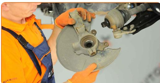
**23** Estrarre il mozzo della ruota dal fuso a snodo. Usare un set di montaggio/smontaggio cuscinetti e boccole. Usa un martello.
