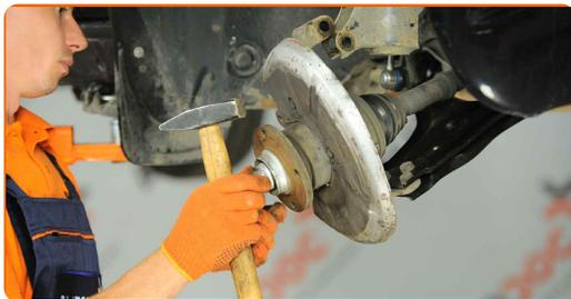
**33** Fissare il supporto di ammortizzazione sul fuso a snodo.
