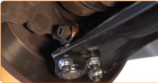
**31** Tratta con del prodotto le scanalature dell'albero di trasmissione del giunto omocinetico. Usa una spazzola metallica. Usa lo spray WD-40.
