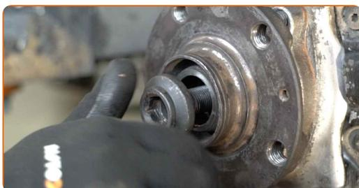
**36** Serrare l'attacco del mozzo. Utilizza una chiave a bussola N°24. Usa una chiave dinamometrica. Serralo fino alla coppia di torsione di 200 Nm. +90°
