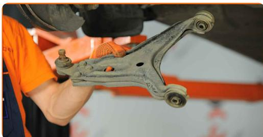
**15** Svita gli elementi di fissaggio che collegano il giunto sferico al braccio di sospensione. Utilizza una chiave combinata N°17. Utilizza una chiave a bussola N°17. Usa una chiave a cricchetto.
