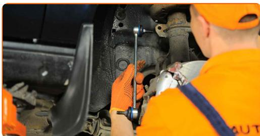
**12** Serra gli elementi di fissaggio che collegano il tirante della barra stabilizzatrice alla barra. Utilizza una chiave combinata N°16. Utilizza una chiave combinata N°17. Usa una chiave dinamometrica. Serralo fino allo coppia di torsione di 40 Nm.
