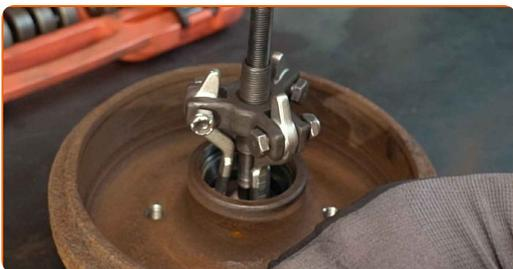
**19** Rimuovere la pista interna del cuscinetto della ruota dal tamburo del freno. Usare un set di montaggio/smontaggio cuscinetti e boccole.
