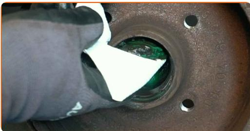
**18** Rimuovere la pista interna del cuscinetto della ruota dal tamburo del freno. Usa un estrattore universale a tre bracci. Usare un set di montaggio/smontaggio cuscinetti e boccole.
