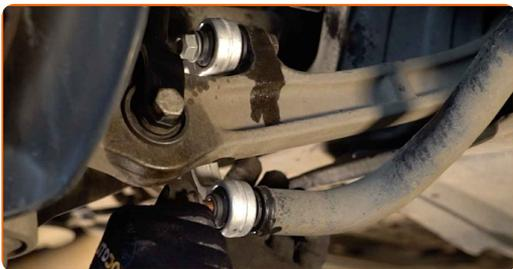
**12** Puntellare il braccio. Usa un cric idraulico per trasmissione.
