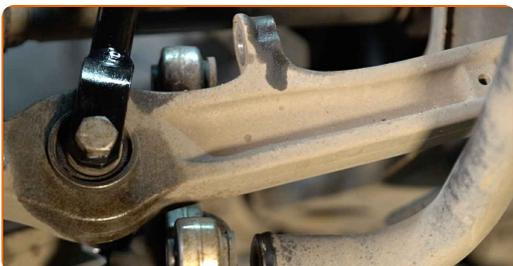
Sostituzione: bielle barra stabilizzatrice - AUDI A8 D3 (4E2, 4E8). Gli esperti di AUTODOC raccomandano:
