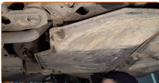
**29** Stringere i bulloni di fissaggio del pannello di protezione. Usa un giravite piatto.
