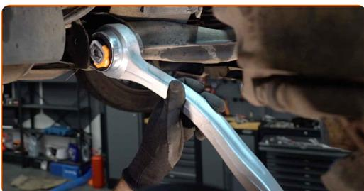
Sostituzione: braccio inferiore anteriore - AUDI A8 D2 (4D2, 4D8). AUTODOC raccomanda:
