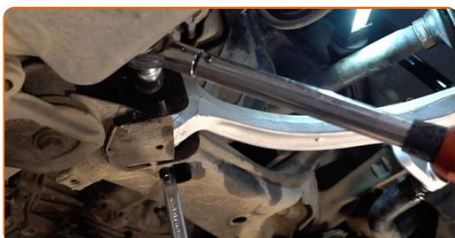
Sostituzione: braccio inferiore anteriore - AUDI A8 D2 (4D2, 4D8). I professionisti raccomandano:
