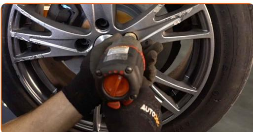
**34** Rimettere il veicolo per terra e, lavorando in ordine incrociato, serrare i bulloni di fissaggio delle ruote. Usa una chiave dinamometrica. Serralo fino allo coppia di torsione di 120 Nm.
