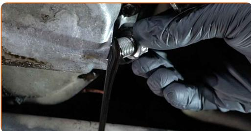
Sostituzione: olio motore e filtro - AUDI A8 (4E2, 4E8). Il consiglio degli esperti di AUTODOC:
