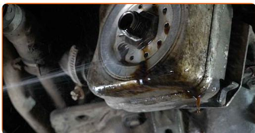
**15** Lubrifica la guarnizione di gomma del filtro nuovo con una piccola quantità di olio fresco.
