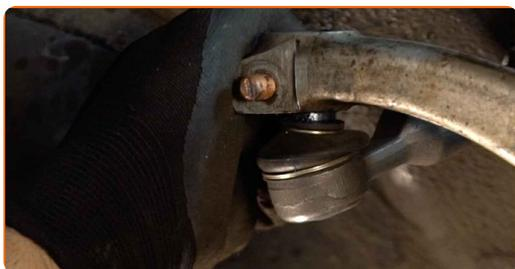
**20** Avvita il dado di serraggio che collega le testine tiranti dello sterzo al fuso a snodo. Utilizza una chiave a bussola N°13. Usa una chiave a cricchetto.
