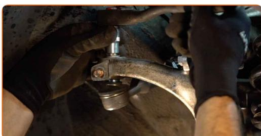
**21** Misura e memorizza la posizione precisa del giunto sferico sulla barra di accoppiamento, oppure conta il numero di giri completi al fine di evitare il disallineamento durante il montaggio successivo. Usa un calibro a corsoio.
