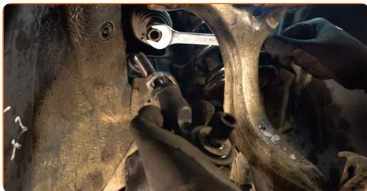
**15** Pulisci le sedi di montaggio delle testine tiranti dello sterzo. Usa una spazzola metallica. Usa lo spray WD-40.
