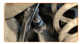
Fissare l'elemento di fissaggio del braccio sul telaio di base. Utilizza una chiave a bussola N°18. Usa una chiave dinamometrica. Serralo fino allo coppia di torsione di 70 Nm. +180°
