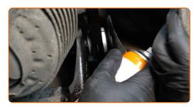
Serra l'elemento di fissaggio che collega il braccio di sospensione allo snodo posteriore. Utilizza una chiave a bussola N°18. Usa una chiave dinamometrica. Serralo fino allo coppia di torsione di 95 Nm.
