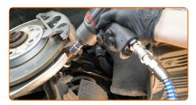
Avvita gli elementi di fissaggio che collegano il braccio di controllo al sottotelaio. Utilizza una chiave combinata N°18. Utilizza una chiave a bussola N°18. Usa una chiave a cricchetto.
