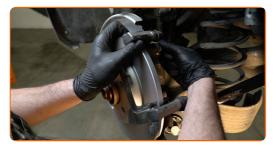
Serrare il sostegno pinza freno. Utilizza una chiave a bussola N°18. Usa una chiave dinamometrica. Serralo fino allo coppia di torsione di 100 Nm. +90°
