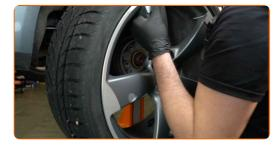
Pulisci gli elementi di fissaggio della pinza freno. Usa una spazzola metallica. Usa lo spray WD-40.
