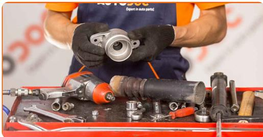
**19** Avvitare il fissaggio superiore dell'asta pistone ammortizzatore. Utilizza una chiave combinata N°17. Usa una chiave regolabile. Usa una chiave dinamometrica. Serralo fino alla coppia di torsione di 25 Nm.
