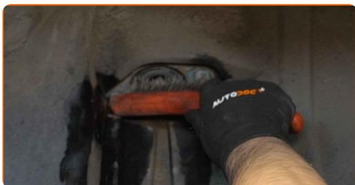
**22** Collocare l'ammortizzatore nell'arco passaruota e fissalo.
