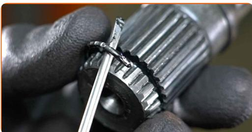
**32** Installare la cuffia del giunto omocinetico sull'asse di trasmissione. Usa un giravite piatto.
