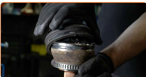
**30** Pulire la sede di montaggio del giunto omocinetico. Usa un detergente spray multiuso.
