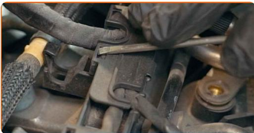
**7** Scollegare i connettori del cablaggio del motore. Usa un giravite piatto.
