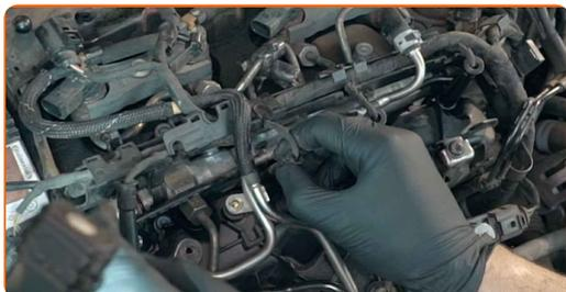
**18** Applicare un prodotto trattante sui connettori del cablaggio del motore. Usa il grasso al silicone.
