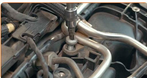
**6** Separare il cablaggio del motore. Usa un giravite piatto.
