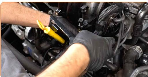
**21** Stringere l'elemento di fissaggio del supporto della pompa dell'aria secondaria. Usa una chiave HEX N.H6. Utilizza una chiave a bussola N°13. Usa una chiave dinamometrica. Serralo fino allo coppia di torsione di 9 Nm.
