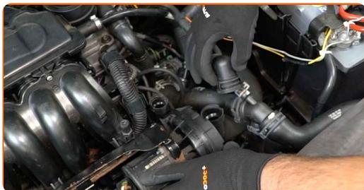
**4** Coprire i canali della pompa dell'aria secondaria con un panno in microfibra per evitare che polvere e sporcizia penetrino all'interno.
