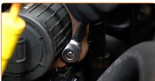
**24** Collegare il connettore della pompa dell'aria secondaria.
