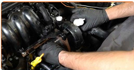
**23** Avvitare gli elementi di fissaggio che collegano la pompa dell'aria secondaria al relativo supporto. Utilizza una chiave combinata N°10.
