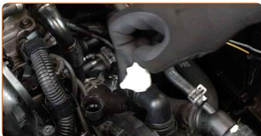
**26** Attaccare i tubi della pompa dell'aria secondaria.
