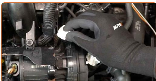
**5** Scollegare il connettore della pompa dell'aria secondaria.
