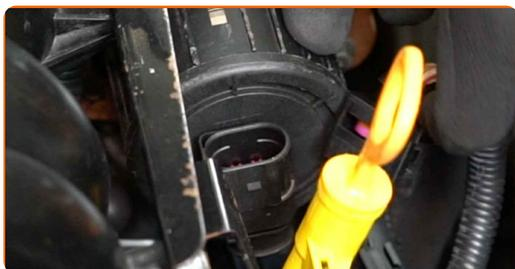
**6** Svitare gli elementi di fissaggio che collegano la pompa dell'aria secondaria al relativo supporto. Utilizza una chiave combinata N°10.
