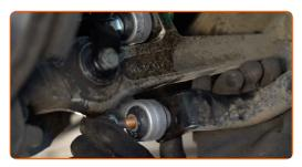
Serra gli elementi di fissaggio che collegano il tirante della barra stabilizzatrice alla barra. Utilizza una chiave combinata N°16. Utilizza una chiave a bussola N°16. Usa una chiave dinamometrica. Serralo fino allo coppia di torsione di 40 Nm. +90°
