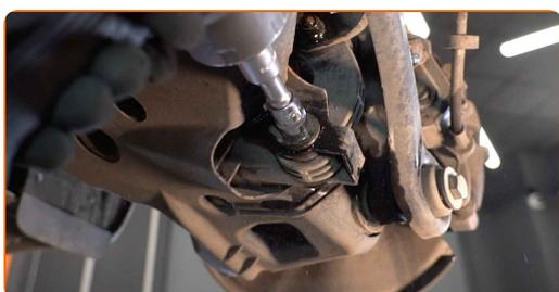
**8** Pulisci le staffe di fissaggio delle boccole dello stabilizzatore. Usa una spazzola metallica. Usa lo spray WD-40.
