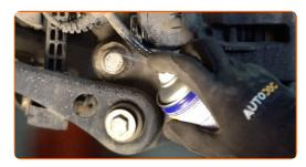
Avvita l'elemento di fissaggio inferiore dell'ammortizzatore. Utilizza una chiave combinata N°21. Utilizza una chiave a bussola N°21. Usa una chiave a cricchetto.
