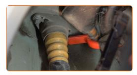
Svita l'elemento di fissaggio superiore dell'ammortizzatore. Utilizza una chiave a bussola N°16. Usa una chiave a cricchetto.
