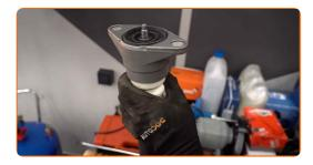
Avvitare il fissaggio superiore dell'asta pistone ammortizzatore. Utilizza una chiave combinata N°17. Utilizza le pinze di autobloccanti. Usa una chiave dinamometrica. Serralo fino allo coppia di torsione di 25 Nm.
