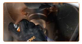
Installa i parasassi del passaruota alla loro sede di montaggio..
