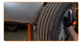
Svita e rimuovi gli elementi di fissaggio del parasassi del passaruota. Usa la chiave Torx T 25.
