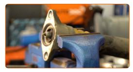
Pulisci l'elemento di fissaggio dell'asta dell'ammortizzatore. Usa una spazzola metallica. Usa lo spray WD-40.
