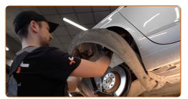
Installa e serra gli elementi di fissaggio del parasassi del passaruota. Usa la chiave Torx T 20.
