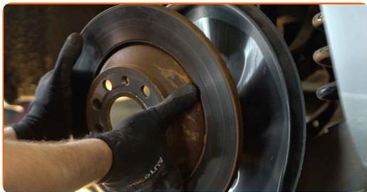
**16** Pulisci gli elementi di fissaggio della lamiera di protezione del disco freno. Usa una spazzola metallica. Usa lo spray WD-40.
