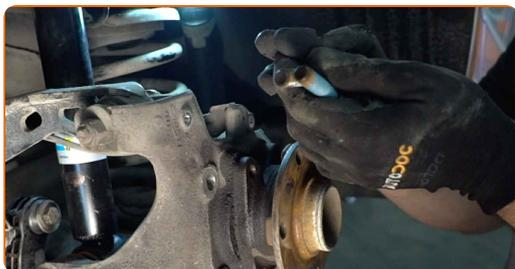
**22** Rimuovere il mozzo integralmente con il cuscinetto, in quanto essi costituiscono un blocco non smontabile. Usa un martello.
