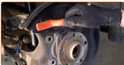
**17** Svita gli elementi di fissaggio della lamiera di protezione del disco freno. Usa la chiave Torx T 20.
