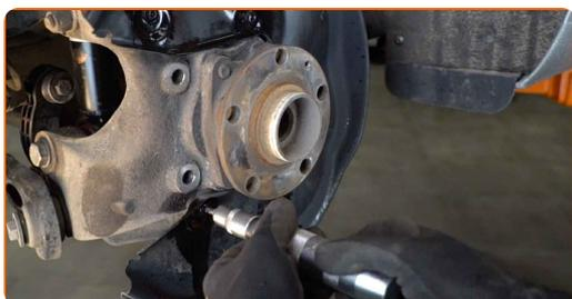
**18** Rimuovi la lamiera di protezione del disco freno.
