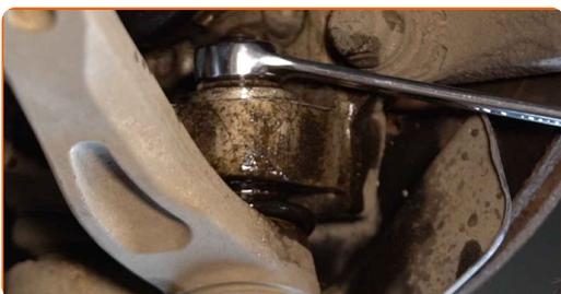
**8** Scollegare il giunto sferico dal fuso a snodo. Usa un estrattore del giunto sferico.
