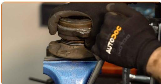
**32** Rimuovere il cuscinetto del mozzo della ruota. Usa un estrattore universale a tre bracci.
