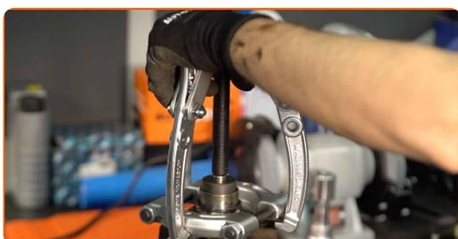
**34** Installare un nuovo cuscinetto del mozzo della ruota e fissarlo.
