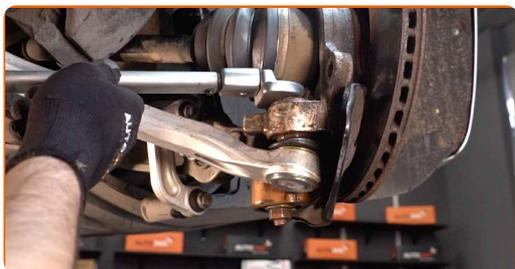
**48** Pulisci le sedi di montaggio delle testine tiranti dello sterzo. Usa una spazzola metallica. Usa lo spray WD-40.
