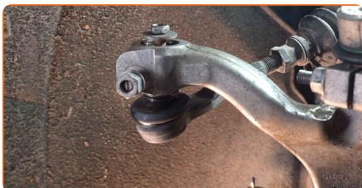
**51** Avvita il dado di serraggio che collega le testine tiranti dello sterzo al fuso a snodo. Utilizza una chiave a bussola N°13. Usa una chiave a cricchetto.
