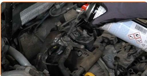
**4** Pulisci il tappo dell'alloggiamento del filtro dell'olio. Usa un detergente spray multiuso.
