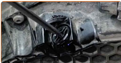
**22** Pulisci la zona del foro di drenaggio della coppa dell'olio. Usa un detergente spray multiuso.
