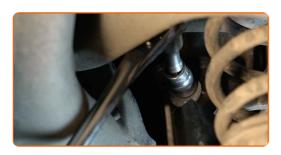
Svita l'elemento di fissaggio che collega il braccio di controllo allo snodo posteriore. Utilizza una chiave a bussola N°18. Usa una chiave a cricchetto.
