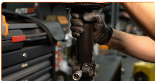
**68** Tratta con del prodotto le sedi di montaggio del puntone dell'ammortizzatore. Usa una spazzola metallica. Usa lo spray WD-40.
