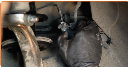
**84** Collega il connettore del sensore di velocità ABS.
