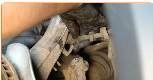
**83** Collegare il cablaggio del sensore ABS.
