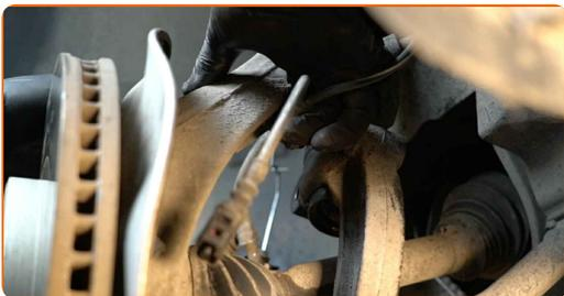
**85** Montare la pinza del freno e fissarla. Utilizza una chiave a bussola N°13. Usa una chiave dinamometrica. Serralo fino allo coppia di torsione di 30 Nm.
