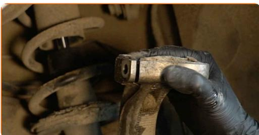
**30** Puntellare il fuso a snodo. Usa un cric idraulico per trasmissione.
