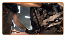
Svita l'elemento di fissaggio superiore del montante supporto ammortizzazione. Utilizza una chiave a bussola N°16. Usa una chiave a cricchetto.
