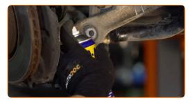
60 Collega la parte sottostante del puntone dell'ammortizzatore.
