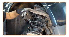
Montare il supporto di ammortizzazione sul dispositivo speciale per la compressione delle molle.
