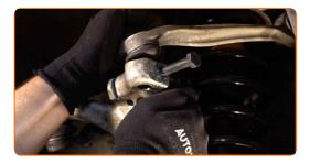
Avvitare gli elementi di fissaggio (2 pezzi) del braccio di controllo superiore. Utilizza una chiave combinata N°18. Utilizza una chiave a bussola N°18.
