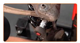
Serra gli elementi di fissaggio che collegano i bracci di controllo al supporto del puntone dell'ammortizzatore. Utilizza una chiave combinata N°16. Utilizza una chiave a bussola N°16. Usa una chiave dinamometrica. Serralo fino allo coppia di torsione di 50 Nm. +90°
