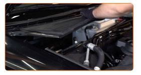
Usa una copertura di protezione del parafango per evitare il danneggiamento della verniciatura e dei componenti in plastica dell'auto.
