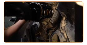
Avvita l'elemento di fissaggio superiore del montante supporto ammortizzazione. Utilizza una chiave a bussola N°16. Usa una chiave a cricchetto. Non lo serrare.
