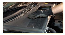
Installa la guarnizione griglia sottoparabrezza.
