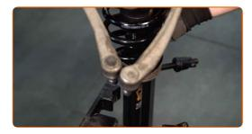
Installare il supporto di ammortizzazione nell'arco passaruota.
