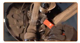
Svita l'elemento di fissaggio inferiore del supporto di ammortizzazione. Utilizza una chiave combinata N°18. Utilizza una chiave a bussola N°18. Usa una chiave a cricchetto.
