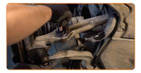
Avvita l'elemento di fissaggio inferiore del puntone dell'ammortizzatore. Utilizza una chiave combinata N°18. Utilizza una chiave a bussola N°18. Usa una chiave a cricchetto.
