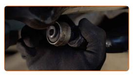
Serra gli elementi di fissaggio del tirante della barra stabilizzatrice.
