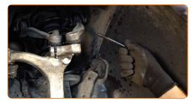
Puntellare il braccio. Usa un cric idraulico per trasmissione.
