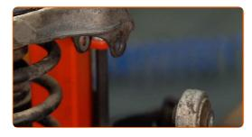
Svita gli elementi di fissaggio che collegano i bracci di controllo al supporto del puntone dell'ammortizzatore. Utilizza una chiave combinata N°16. Utilizza una chiave a bussola N°16. Usa una chiave a cricchetto.
