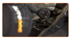
Allenta gli elementi di fiìssaggio superiori del supporto dell'ammortizzatore. Utilizza una chiave a bussola N°16. Usa una chiave a cricchetto.
