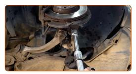
Serrare gli elementi di fissaggio della leva di manovra superiore (2 pezzi). Utilizza una chiave combinata N°18. Utilizza una chiave a bussola N°18. Usa una chiave dinamometrica. Serralo fino allo coppia di torsione di 45 Nm.
