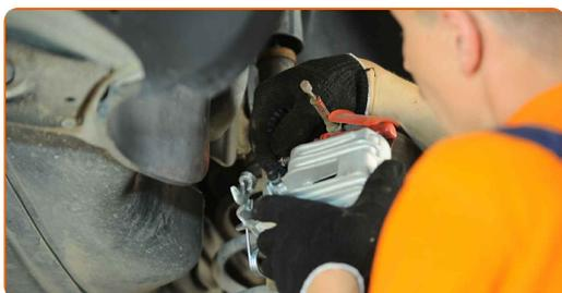
**20** Fissa il cavo del freno di stazionamento con il clip di fissaggio. Usa un giravite piatto.
