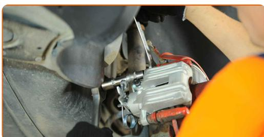
**19** Installa il cavo del freno di stazionamento nella staffa della pinza del freno. Usa un giravite piatto.
