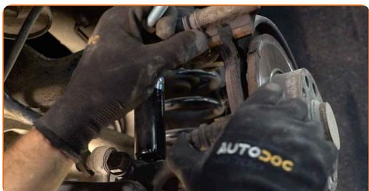
**13** Pulisci gli elementi di fissaggio del disco freno. Usa una spazzola metallica. Usa lo spray WD-40.
