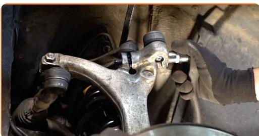
**66** Installa il puntone stabilizzatore trasversale.
