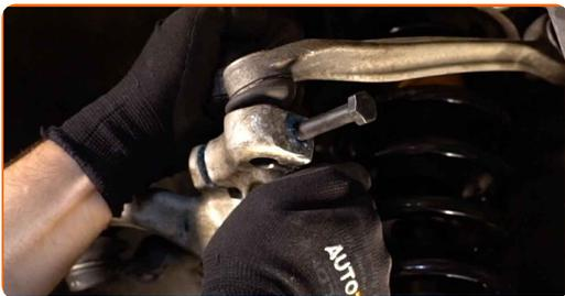
**65** Avvitare gli elementi di fissaggio (2 pezzi) del braccio di controllo superiore. Utilizza una chiave combinata N°18. Utilizza una chiave a bussola N°18.
