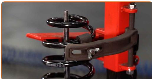
**44** Installa il nuovo supporto, il parapolvere e il tampone dell'ammortizzatore.
