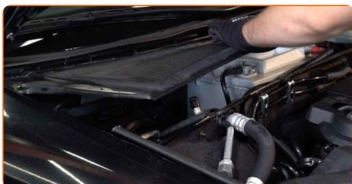
**4** Usa una copertura di protezione del parafranco per evitare il danneggiamento della verniciatura e dei componenti in plastica dell'auto.
