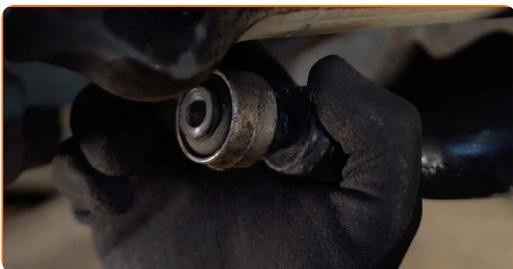
**67** Serra gli elementi di fissaggio del tirante della barra stabilizzatrice.
