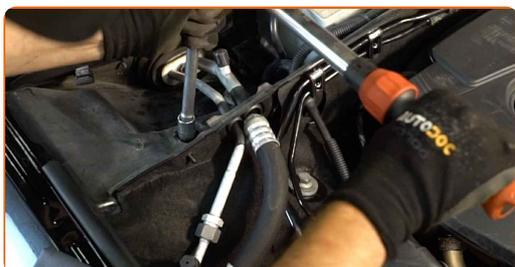
**80** Tratta con del prodotto gli elementi di fissaggio del supporto del puntone dell'ammortizzatore. Usa il grasso al rame.
