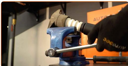
**23** Pulisci le sedi di montaggio dell'ammortizzatore. Usa una spazzola metallica. Usa lo spray WD-40.
