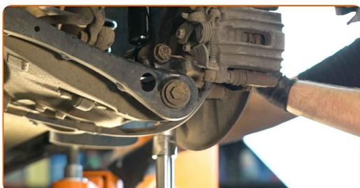
**30** Stringi l'elemento di fissaggio inferiore dell'ammortizzatore. Utilizza una chiave combinata N°21. Utilizza una chiave a bussola N°21. Usa una chiave dinamometrica. Serralo fino allo coppia di torsione di 150 Nm. +90°
