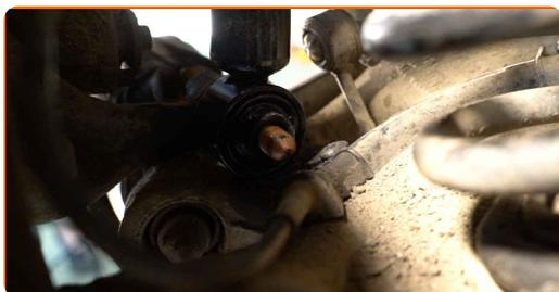
**28** Avvita gli elementi di fissaggio inferiori dell'ammortizzatore. Utilizza una chiave combinata N°21. Utilizza una chiave a bussola N°21. Usa una chiave a cricchetto.
