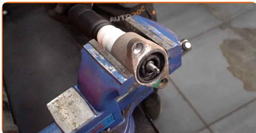
**21** Avvitare il fissaggio superiore dell'asta pistone ammortizzatore. Usa la chiave a bussola per ammortizzatore DDN°6. Utilizza una chiave a bussola N°16. Usa una chiave dinamometrica. Serralo fino allo coppia di torsione di 25 Nm.
