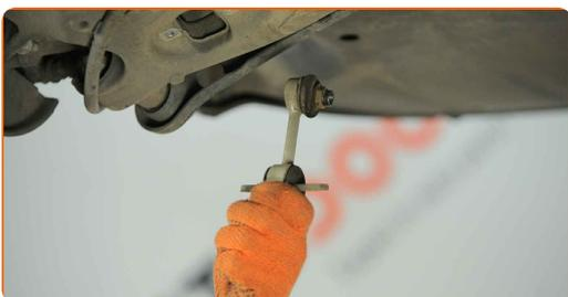
**Sostituzione: biellette barra stabilizzatrice - AUDI A4 Cabrio (8H7, B6, 8HE, B7).**
