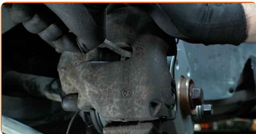
**10** Pulisci l'area nella quale il tubo del freno è connesso alla pinza, e la zona dei perni guida. Usa una spazzola metallica. Usa un pulitore freni.
