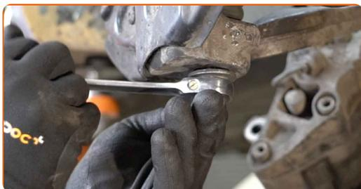
**72** Collegare il cablaggio del sensore ABS.
