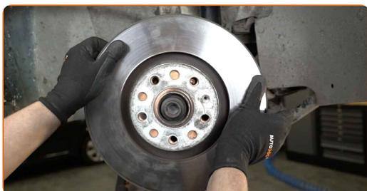
**76** Serrare l'attacco del disco freno. Usa la chiave Torx T 30. Usa una chiave dinamometrica. Serralo fino allo coppia di torsione di 5 Nm.
