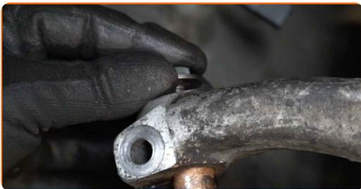
**63** Avvitare il bullone di fissaggio della testina sterzo. Utilizza una chiave combinata N°13.
