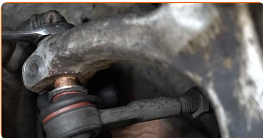
**64** Avvita il dado di serraggio che collega le testine tiranti dello sterzo al fuso a snodo. Utilizza una chiave a bussola N°15. Usa una chiave a cricchetto.
