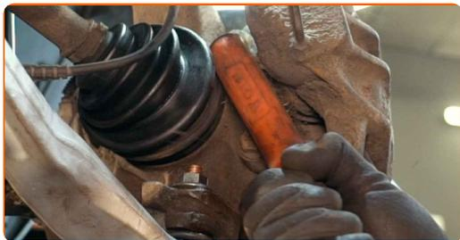
**9** Svitare l'attacco della staffa pinza freno. Utilizza una chiave a bussola N°17. Usa una chiave a cricchetto. Usa un giramaschi.
