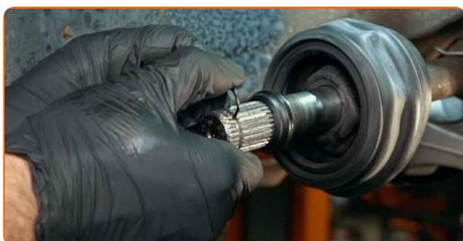
**38** Installare il giunto omocinetico. Usare un set di montaggio/smontaggio cuscinetti e boccole. Usa un martello.
