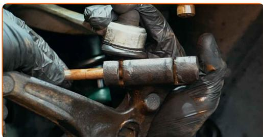
**46** Serrare gli elementi di fissaggio del braccio superiore. Utilizza una chiave combinata N°16. Utilizza una chiave a bussola N°16. Usa una chiave dinamometrica. Serralo fino allo coppia di torsione di 40 Nm.
