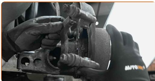
**14** Pulire l'elemento di fissaggio del disco del freno. Usa una spazzola metallica. Usa lo spray WD-40.
