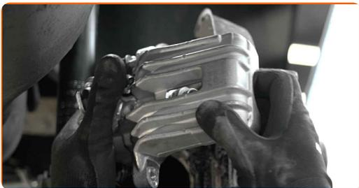
Usare un filo per legare la pinza alla sospensione o carrozzeria senza scollegarla dal tubo flessibile del freno, al fine di evitare la depressurizzazione del sistema.
