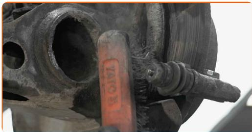
**12** Svitare l'attacco della staffa pinza freno. Usa una chiave HEX N.H8. Usa una chiave a cricchetto. Usa un giramaschi.
