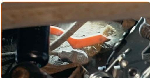
**7** Pulisci gli elementi di fissaggio della pinza freno. Usa una spazzola metallica. Usa un pulitore freni.
