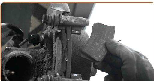
**11** Pulisci gli elementi di fissaggio del supporto pinza freno. Usa una spazzola metallica. Usa lo spray WD-40.
