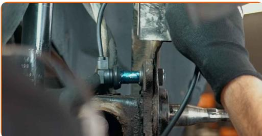
**Sostituzione: sensore ABS - AUDI A4 Avant (8D5, B5). Il consiglio degli esperti di AUTODOC:**
