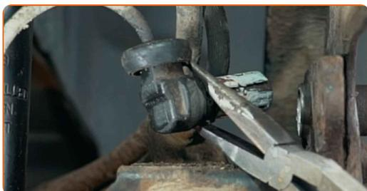
**27** Pulire la sede di montaggio del sensore ABS. Usa una spazzola metallica. Usa lo spray WD-40. Usa un pulitore freni.
