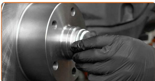
**37** Pulire il sostegno pinza freno da sporco e polvere. Usa una spazzola metallica. Usa un pulitore freni.
