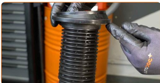
45 Installare il montante superiore del puntone insieme al bump stop (fine corsa).
