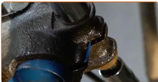
**60** Installa il bullone dell'albero di trasmissione e serralo. Usa la chiave a bussola 12 punte n.24. Usa una chiave a cricchetto.
