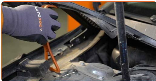
**6** Pulisci gli elementi di fissaggio del supporto superiore del puntone dell'ammortizzatore. Usa una spazzola metallica. Usa lo spray WD-40.
