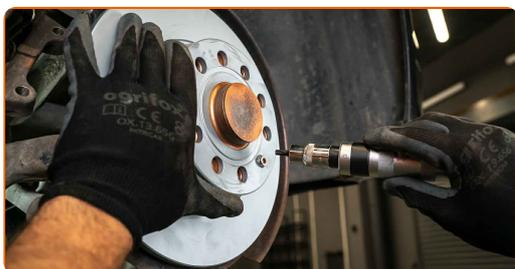
**16** Serrare l'attacco del disco freno. Usa la chiave Torx T30. Usa una chiave dinamometrica. Serralo fino allo coppia di torsione di 4 Nm.
