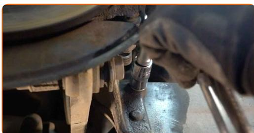
**12** Installare l'elemento che fissa l'asta allo stabilizzatore e serrarlo. Utilizza una chiave combinata N°14. Usa la chiave XZN n.6. Utilizza una chiave a bussola N°15. Usa una chiave dinamometrica. Serralo fino allo coppia di torsione di 45 Nm.
