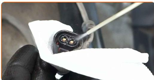
**68** Collega il connettore del sensore di velocità ABS.
