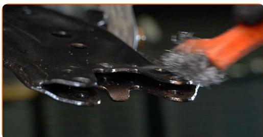
**53** Pulire l'elemento di fissaggio della testina del tirante. Usa una spazzola metallica. Usa lo spray WD-40.
