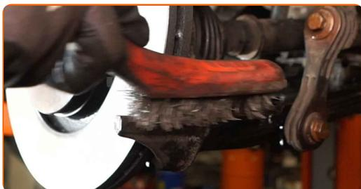
**77** Installare la pinza del freno e fissarla.
