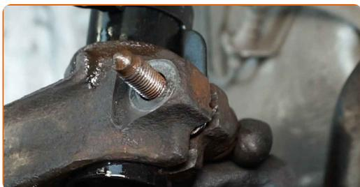
**57** Installare l'albero di trasmissione.
