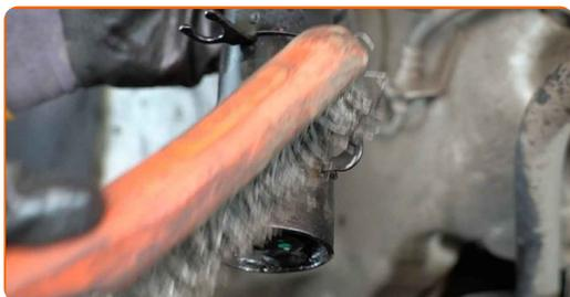
**50** Pulisci le scanalature del giunto omocinetico dell'albero di trasmissione. Usa una spazzola metallica. Usa lo spray WD-40.
