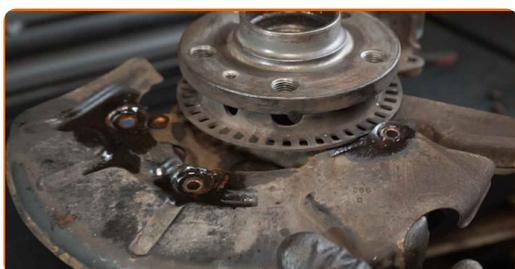
**39** Estrarre il mozzo della ruota dal fuso a snodo. Usa un set di montaggio/smontaggio cuscinetti e boccole.
