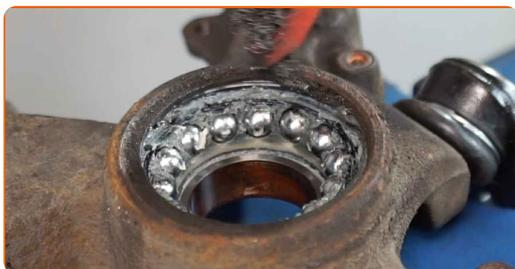
**41** Rimuovere l'anello di sicurezza del cuscinetto mozzo ruota. Usa le pinze per anelli di sicurezza.
