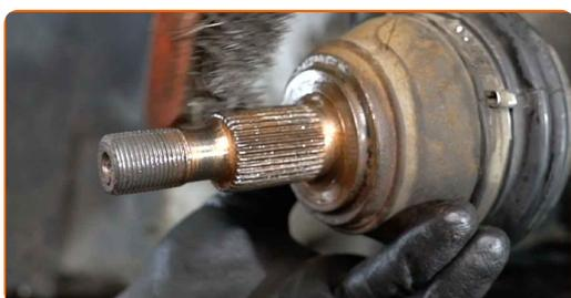
**51** Tratta con del prodotto le scanalature dell'albero di trasmissione del giunto omocinetico. Usa il grasso al rame.
