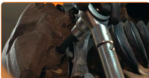
**22** Montare i tappi dei parapolvere delle guide pinza freno.
