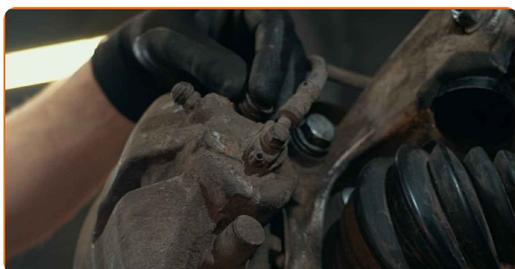
**23** Installare la molla di fissaggio della pinza freno. Usa un piede di porco.
