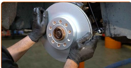
**21** Serrare l'attacco del disco freno. Usa la chiave Torx T 30. Usa una chiave dinamometrica. Serralo fino allo coppia di torsione di 4 Nm.
