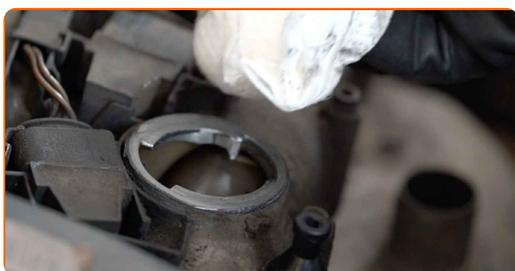
**21** Installa il bocchettone di riempimento dell'olio. Avvita il bocchettone di riempimento dell'olio.
