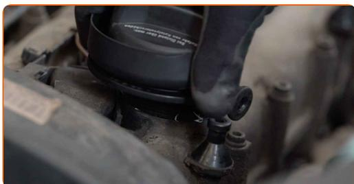
**22** Collega il tubo di ventilazione del carter motore al bocchettone di riempimento dell'olio.
