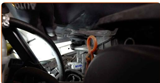
**4** Rimuovere la copertura del motore.
