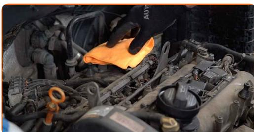
24 Montare il coperchio motore e fissarlo. Assicurati di sentire un clic indicante che si trova installato saldamente.
