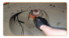
Installare il supporto di ammortizzazione nell'arco passaruota.
