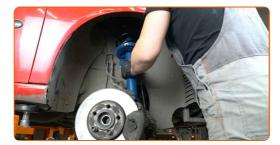
Avvita l'elemento di fissaggio superiore del montante supporto ammortizzazione. Non lo serrare.
