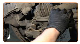
Avvita gli elementi di fissaggio del giunto sferico. Utilizza una chiave a bussola N°13. Usa una chiave a cricchetto.
