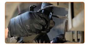
Sgancia gli elementi di fissaggio che collegano il puntone dell'ammortizzatore al fuso a snodo. Usa una chiave a bussola specifica per rimuovere l'ammortizzatore. Usa una chiave a cricchetto.
