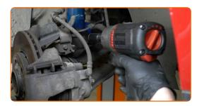
Serra gli elementi di fissaggio inferiori che collegano l'ammortizzatore al fuso a snodo. Utilizza una chiave a bussola N°18. Usa una chiave dinamometrica. Serralo fino allo coppia di torsione di 60 Nm. +90°
