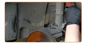
Svita gli elementi di fissaggio che collegano il tirante della barra stabilizzatrice al puntone dell'ammortizzatore. Utilizza una chiave a bussola N°17. Usa una chiave a cricchetto.
