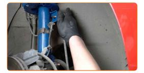
Serra gli elementi di fissaggio che collegano il tirante della barra stabilizzatrice al puntone dell'ammortizzatore.
