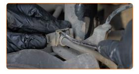
Scollegare il cablaggio del sensore ABS.
