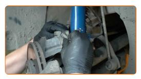
Installa il tubo flessibile del freno al clip di ritenuta.
