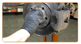
Serra il dado dell'albero di trasmissione. Utilizza una chiave a bussola N°36. Usa una chiave dinamometrica. Serralo fino allo coppia di torsione di 50 Nm. +45°
