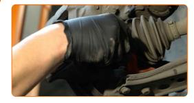
Svita gli elementi di fissaggio che collegano il giunto sferico al braccio di sospensione. Utilizza una chiave a bussola N°13. Usa un giramaschi.
