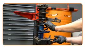
Tratta con del prodotto le sedi di montaggio del puntone dell'ammortizzatore. Usa una spazzola metallica. Usa lo spray WD-40.
