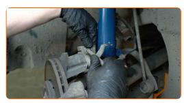
67 Collegare il cablaggio del sensore ABS. Usa le pinze per pompa ad acqua.
