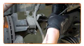
Svita l'elemento di fissaggio superiore del montante supporto ammortizzazione.
