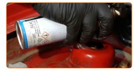
Installare il coperchio di protezione del supporto di ammortizzazione.
