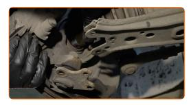
Installa l'albero di trasmissione all'interno del mozzo della ruota.
