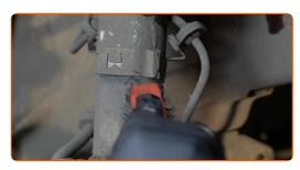
Rimuovi il clip di ritenuta del tubo flessibile del freno.
