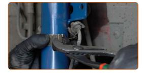
68 Installa il puntone stabilizzatore trasversale.
