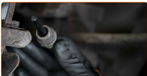
**20** Pulisci le macchie di grasso vecchio e di ruggine, se ce ne sono, dai perni guida della pinza e dai parapolveri dei perni guida. Usa un pulitore freni.
