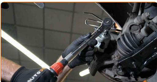
**27** Montare i tappi dei parapolvere delle guide pinza freno.
