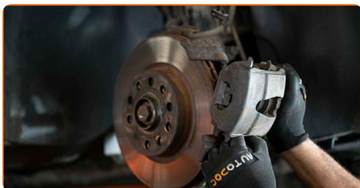
Sostituzione: pinza de freno - AUDI A2 (8Z0). AUTODOC raccomanda:
