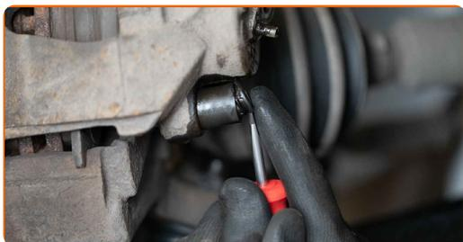
**28** Collegare il connettore elettrico del sensore ABS. Collegare la presa del sensore di usura delle pastiglie dei freni.
