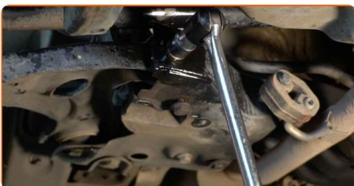
**8** Svita gli elementi di fissaggio posteriori che collegano il braccio di sospensione al sottotelaio. Utilizza una chiave combinata N°18. Utilizza una chiave a bussola N°18. Usa un giramaschi.
