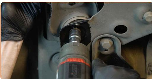
**9** Rimuovi i bulloni di fissaggio. Utilizza una chiave a bussola N°18.
