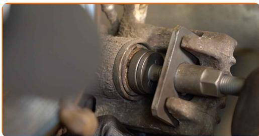
**13** Svitare le viti di fissaggio del disco freno e rimuoverlo. Usa la chiave Torx T30.
