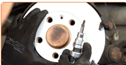
**18** Serrare l'attacco del disco freno. Usa la chiave Torx T30. Usa una chiave dinamometrica. Serralo fino allo coppia di torsione di 4 Nm.
