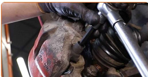
**23** Montare i tappi dei parapolvere delle guide pinza freno.
