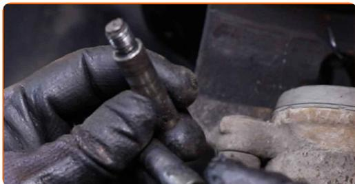
**15** Pulisci i perni guida della pinza freno. Usa un pulitore freni.
