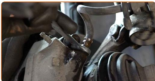
**13** Allentare l'elemento di fissaggio che collega l'impianto dei freni al tubo flessibile del freno. Utilizza una chiave combinata N°11.
