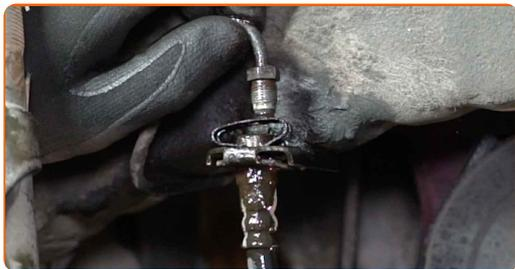
**15** Rimuovi la fascetta di fissaggio del tubo freni.
